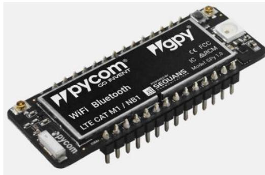
Fig.9. GPy LTE CAT-M1/NB1 module[9]
